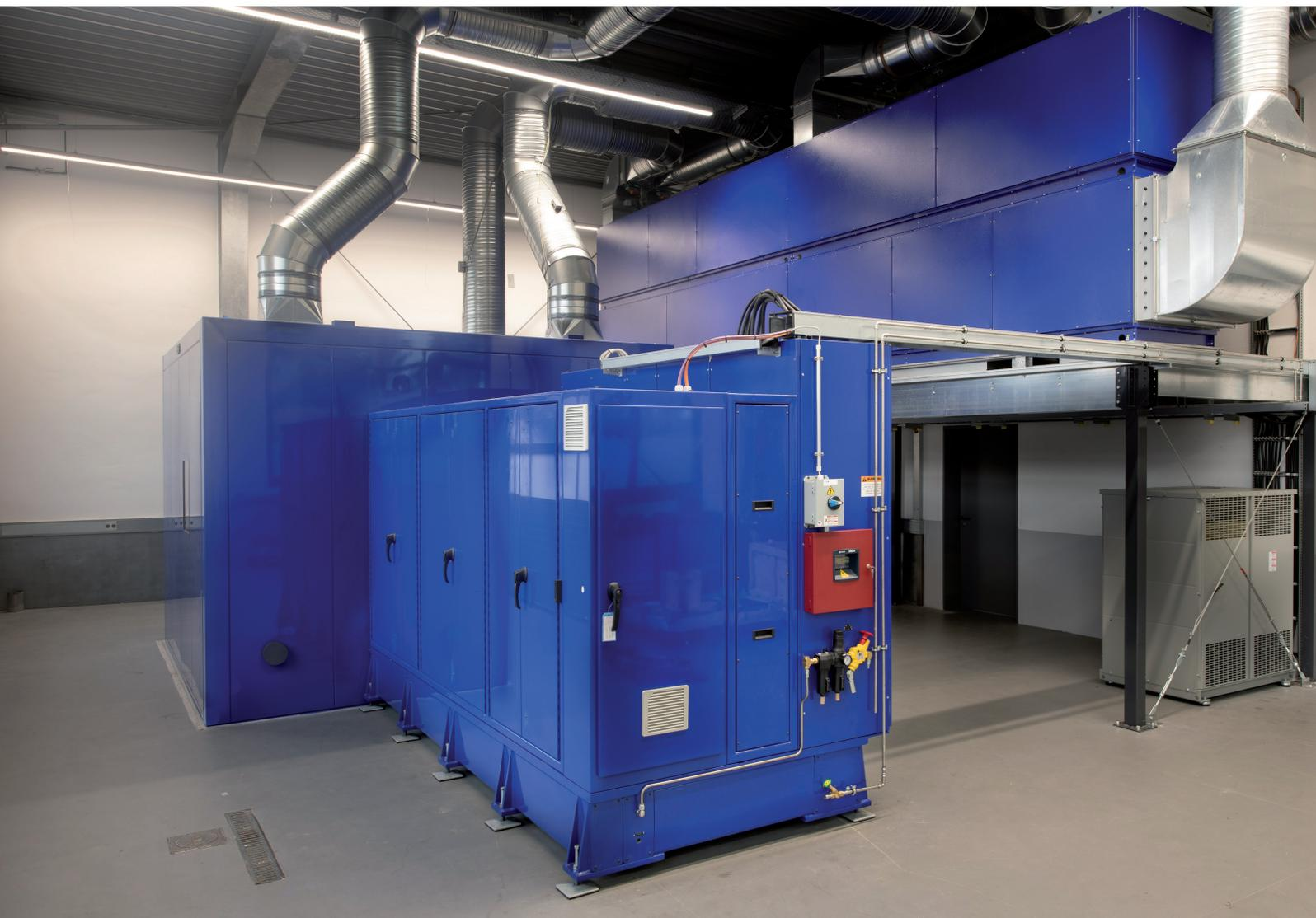
Installierter Schwungmassenprüfstand II: rechts mit Umwelt-Konditionierungs-Unit
